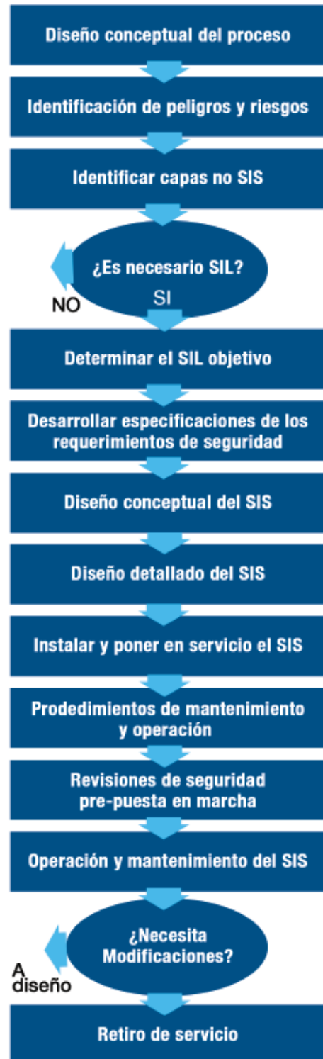
Figura D: El Ciclo de Vida de Seguridad es un método secuencial para desarrollar un Sistema Instrumentado de Seguridad (SIS). Referencias a Ciclo de Vida de Seguridad se pueden encontrar en ANSI/ISA 84.00.01 Partes 1-3; IEC 61508 Parte 1 e IEC 61511 Partes 1-3.
