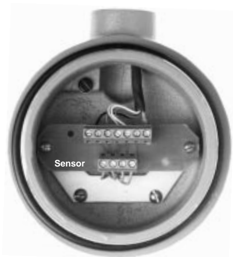
Figura 8 – Conexiones del alojamiento del sensor remoto
