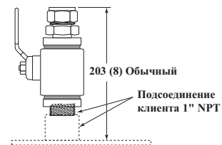
1" NPT шаровой клапан в 316 SST с фитингом уплотнения (TFE кольца) код заказа 089-5218-001
