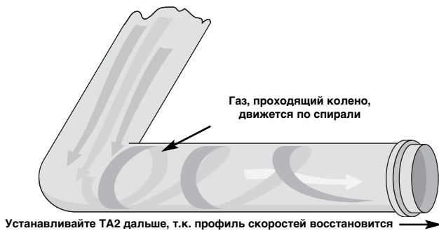
Движение потока в трубе по спирали
